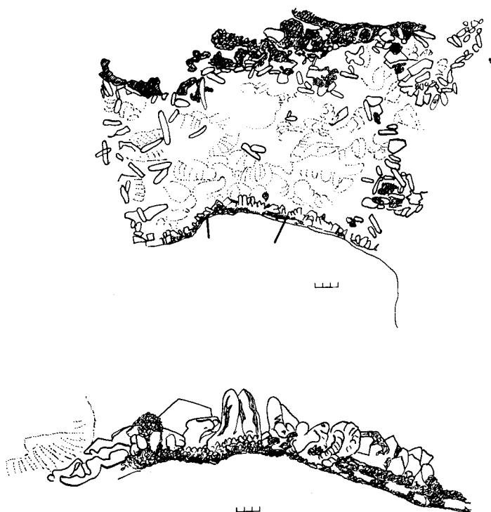
Abb. 11. Schliff Nr. 5664, Ornbau 57 (1 Teilstrich = 12,5 \mu ); Kristallisation von Apatit in einem mit Kaolinit erfüllten Hohlraum. Kaolinit punktiert. Auf dem unteren Teil der Zeichnung ist der durch zwei Striche begrenzte Teil der Unterkante in größerem Maßstab gezeichnet (1 Teilstrich = 3,7 \mu ).
